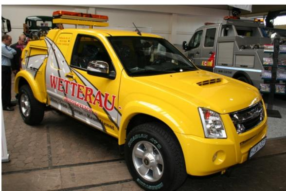
Anforderungen an das Fahrzeug. So wird auch der Abschleppwagen (AWU) für Pkw-Einsätze verstärkt nachgefragt, denn dieser ist in der Unterhaltung im Vergleich sehr kostengünstig und kann mit dem Führerschein der Klasse BE gefahren werden. Außerdem ist dieser aufgrund seiner Wendigkeit für den Stadt- und Tiefgarageneinsatz bestens geeignet. Die Kriterien der Bundesländer, in denen die Polizeiauftragsvermittlung über die Verkehrsvereine läuft, spielten auch bei der Auswahl der
